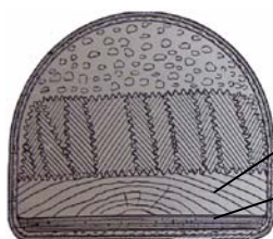
Abb. 14a: Langschnitt und Durchschnitt des gotischen Hornschichtbogen. – a) Sehnenlagen am Bogenrücken; b) Zusammengeleitmer Hornkern; c) Sehnenlagen am Bogenbauch; d) Deckschichten; e) Lagerleiste aus Horn; f) Sehnenlager der Gebrauchsehne; g) Lager der Hilfssehne. (Rohde, 1993.)
