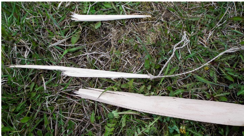
Kuva 20. Vaikka pituusammuntajousen materiaalit olisivat valittu oikein, jousi tehty hyvin, niin aina voi sattua kaikkea, kun joustia rääkätään liikaa. Tämä (kin) jousi hajosi hienosti moneksi kappaleeksi.
