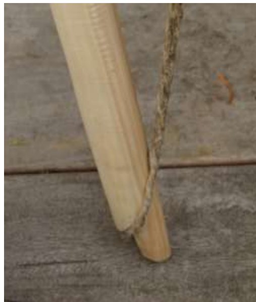
Figuur 4: links een versterkte staart en een timmermanssteek (3-draads henneppees van gekleurd draad), rechts een aangesplitst oog (6-draads naturel henneppees). Bij de timmermanssteek loopt de pees over zichzelf, wat een puntbelasting op de pees veroorzaakt. De pees zal altijd op deze plek breken. Bij het aangesplitste oog wordt de kracht meer gelijkmatig verdeeld, waardoor de pees als geheel sterker wordt.
