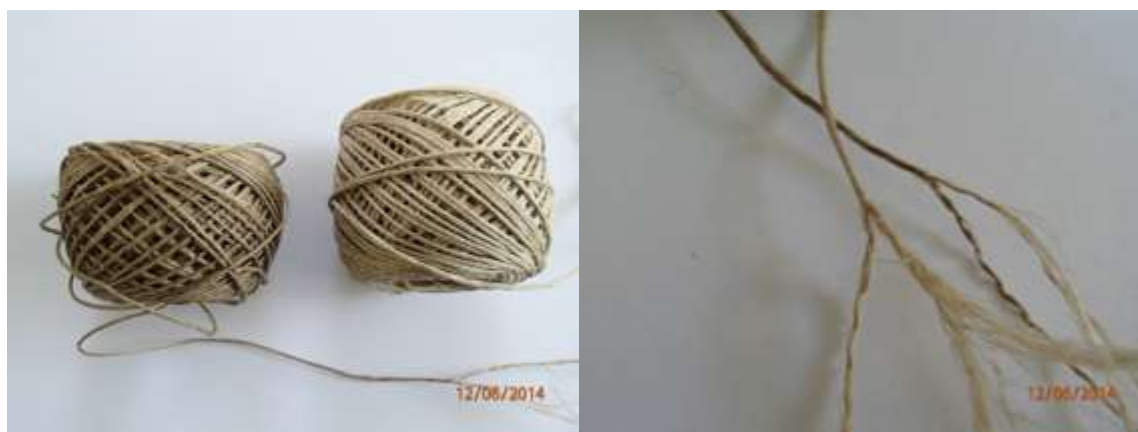
Figuur 2: Het linker bolletje pakdraad is de betere kwaliteit, en waarschijnlijk pure hennep, want 25% sterker dan het rechter bolletje 25# vs 18#. (linnen of linnen/hennep mengsel). Op de foto rechts zie je de beide draden: de lichtbeige draad is pluiziger, de bruine draad is meer sluijk, langdradig. Touw wordt traditioneel gemaakt van (kortvezelig) afval. Een echte 16 e eeuwse henneppees was waarschijnlijk wat dunner dan die je nu kunt maken.
