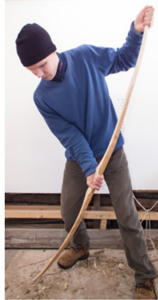
Kuva 14. Lattiatilleröintiä. Jousi on vielä liian jäykkä. Lattiatilleröinnissä auttaa huomattavasti, jos käytössä on valmis jousi, johon taipumaa ja jäykkyyttä voi verrata. 📷 Oula Reiniaho
