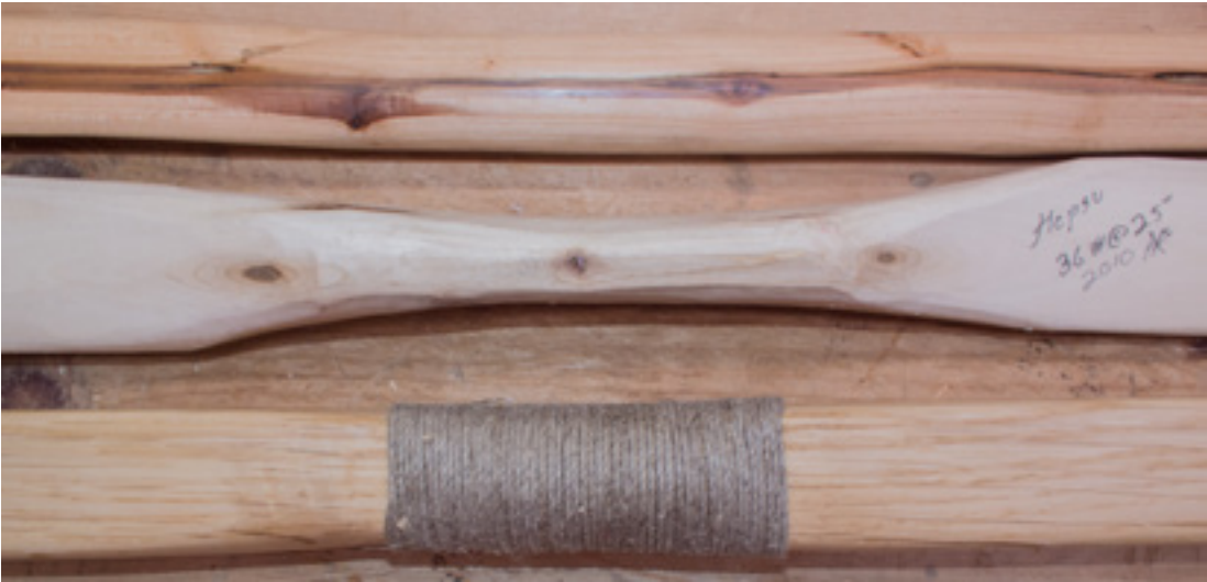
Kuva 11. Kuvassa ylinnä on läpitaipuva jousi, jonka kahvaa ei ole muotoiltu yhtään. Sen alla jäykkäkahvainen jousi, jonka kahva on paksu ja kapea. Alinna kahva, joka on aavistuksen paksumpi kuin muu lapa. Pellanarupunos.
