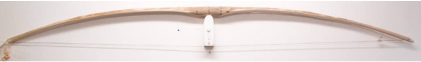
Kuva 17. Jousi viritettyä ensimmäistä kertaa jännteellä. Jänneväli on noin 10 senttimetriä.
