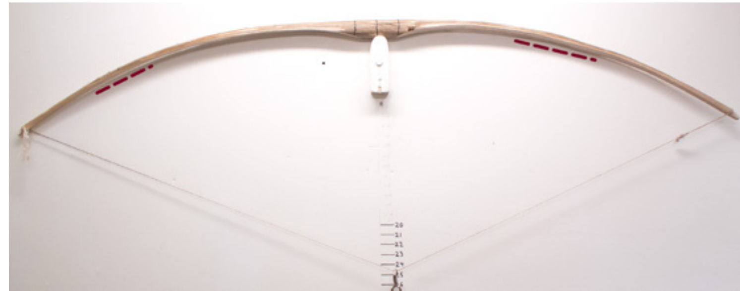
Kuva 15. Tilleriä on hieman korjattu mutta se ei ole vielä hyvä. Punaisella katkoviivalla on merkitty jäykät kohdat, joita pitää työstää varovasti. Ylälapa on oikealla.
