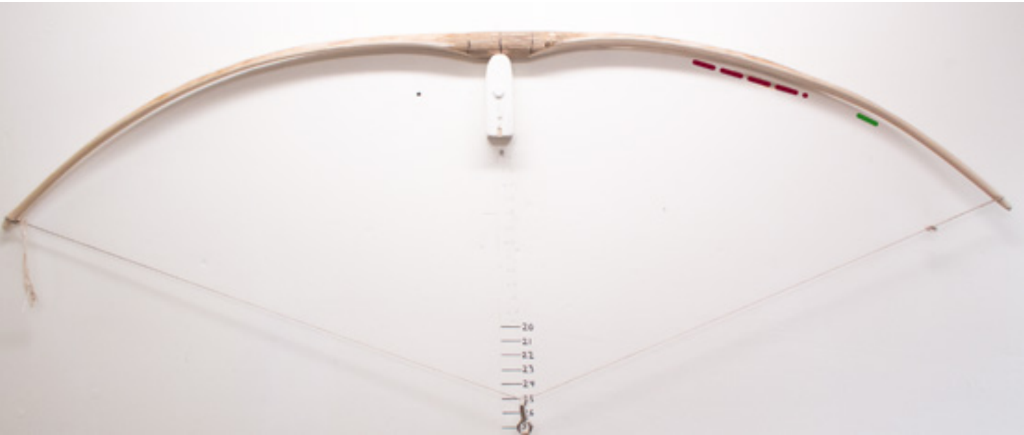
Kuva 18. Tilleri alkaa olla jo hyvin lähellä lopullista. Vasen lapa on hyvä. Oikeassa lavassa on vielä ykso liian jäykkä kohta (merkitty punaisella katkoviivalla). Vihreällä on merkitty kohta, joka taipuu jo aavistuksen liikaa.
