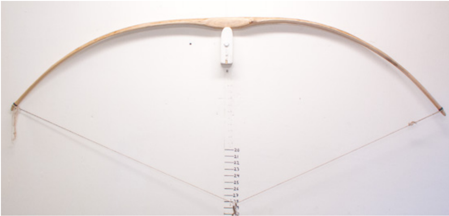
Kuva 19. Jousi tilleröitynä ja vedettynä 28 tuuman vetoon. Oikeassa lavassa saattaa edelleen olla aavistuksen jäykkä kohta mutta sillä ei ole merkitystä. Jousi taipuu nädisti ja tilleri voi hieman muuttua sisäänammunnan aikana.
